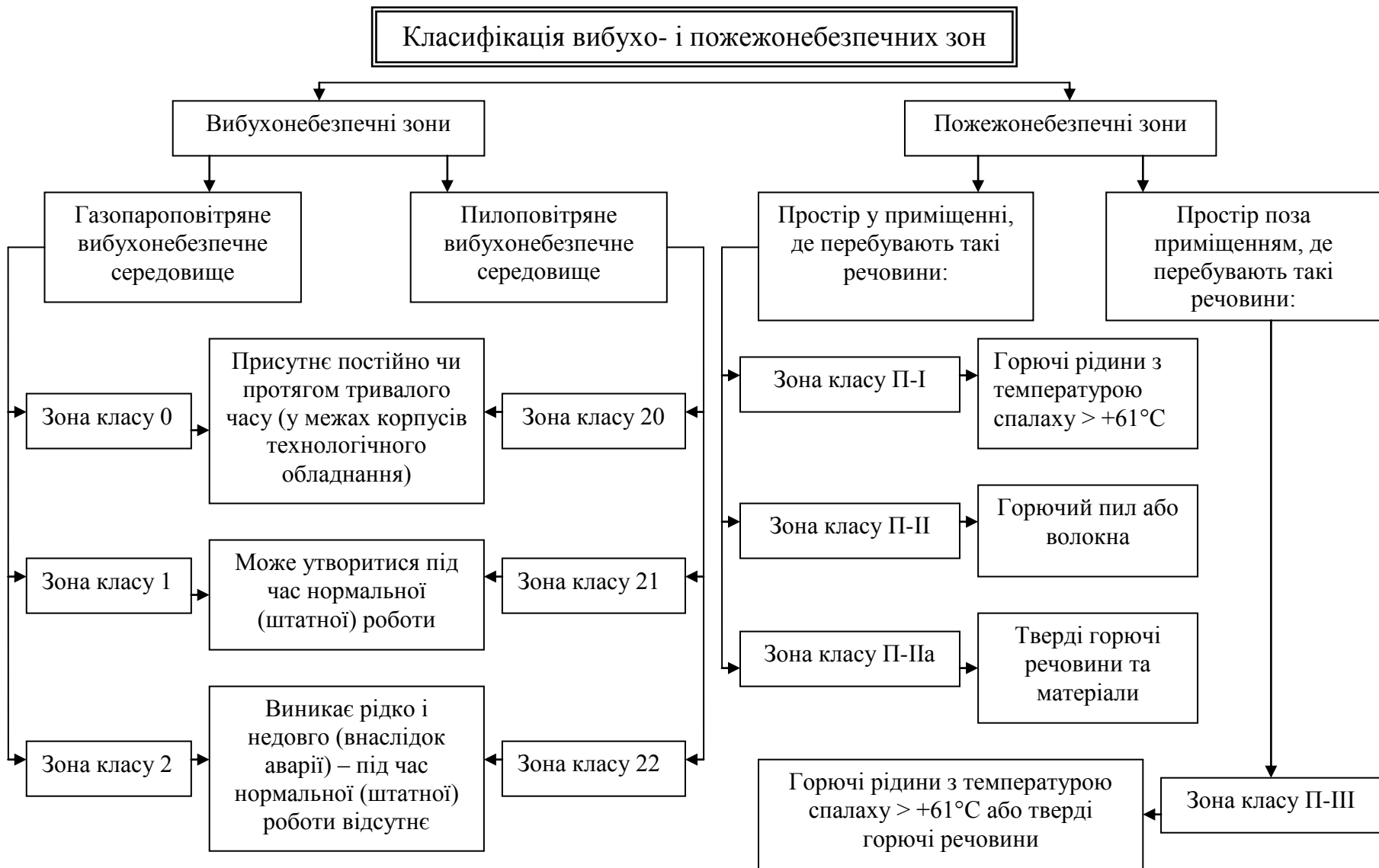
Рис. 6.1. Класифікація вибухо- і пожежонебезпечних зон згідно з ПУЕ
